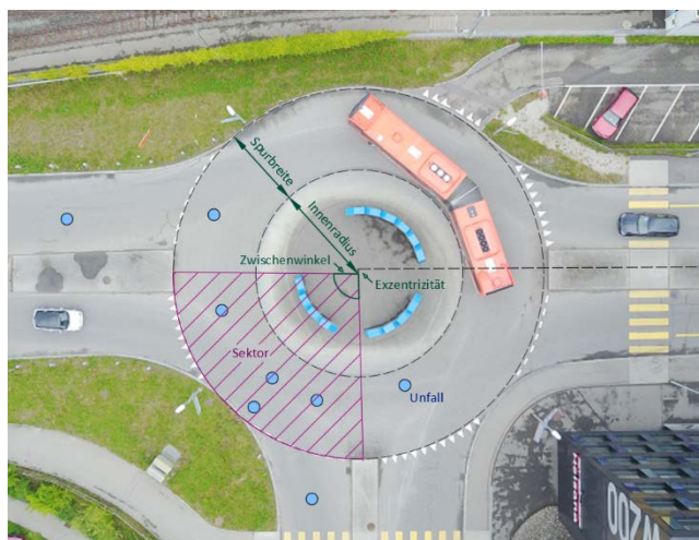
Abb. 1: Beispiel eines Kreisels mit den Infrastrukturelementen des Kreisels (Spurbreite und Innenradius) und des Sektors (Zwischenwinkel und Exzentrizität) sowie einigen Unfällen
