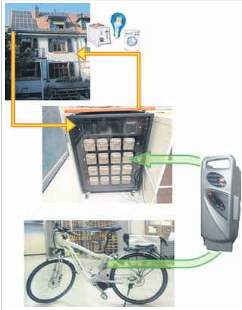
Das System im Bild: Gebrauchte Akkus – hier von einem Flyer – werden in einem 2nd-Life-Speicher vereint und speichern Energie eines dauerhaften Energielieferanten (hier Fotovoltaik) zur späteren Nutzung (hier für Haushaltsgeräte).
