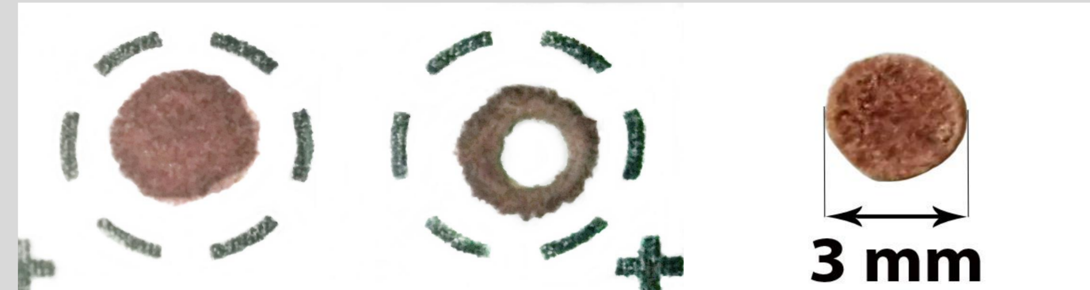
Abb 2: Ausgestanzter Spot von 3mm Durchmesser (Vol.: ~3µl)
